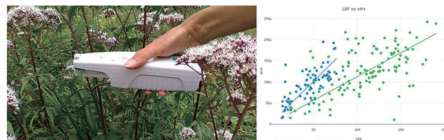
図3. 野外測定用分光光度計 (MultispeQ) による測定と解析例
