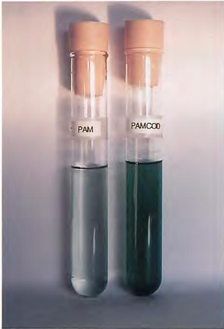
*Synechocystis* sp. PCC 6803 の塩耐性能の遺伝子工学的改変。土壌細菌 *Arthrobacter globiformis* から単離したコリンオキシダーゼ遺伝子の導入はベクタープラスミド pAM1044 を用いておこなった。塩条件, 400mM NaCl。 (a) ベクタープラスミドだけを導入した *Synechocystis* (対照実験)。; (b) コリンオキシダーゼ遺伝子を導入した形質転換 *Synechocystis*。
