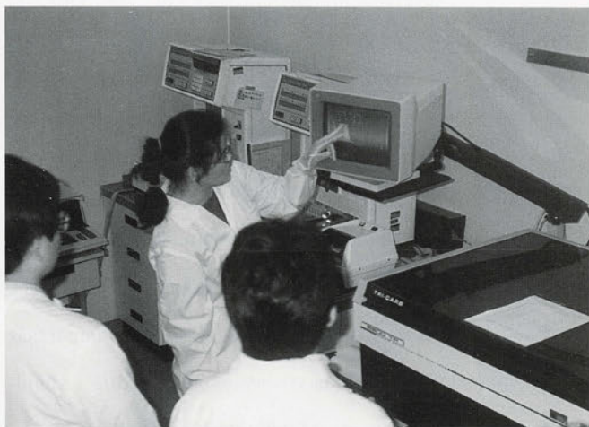
初めて RI を取扱う者を対象にした教育及び訓練—液体シンチレーションカウンタを使用したベータ線の測定実習
