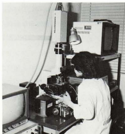
高コントラストテレビシステムを備えた マイクロマニピュレーション装置
