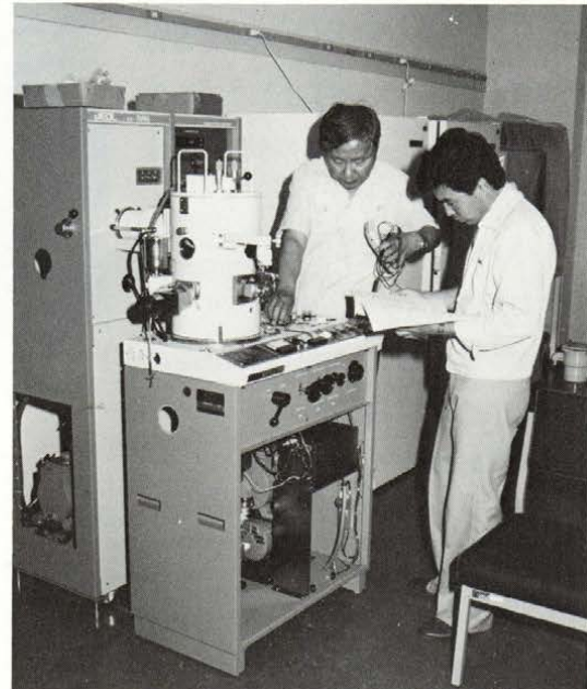
設置調整中の万能型凍結試料作製装置、この装置で生体組織を瞬間的に凍結し、細胞構造がよく保存された電子顕微鏡観察試料を作製する。
