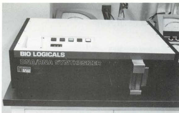
変異遺伝子作製のための全自動 DNA 合成装置
