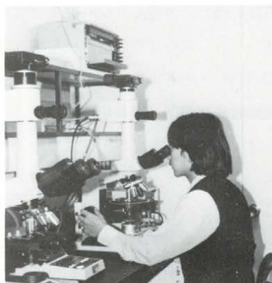
ノマルスキー・レクチファイヤ顕微鏡（平本が昭和53年に考案した微分干渉顕微鏡に変換可能な偏光顕微鏡）による分裂細胞の観察
