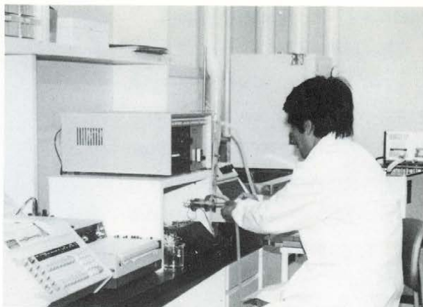
生体の微量成分の分析に威力を発揮する高速液体クロマトグラフィー
