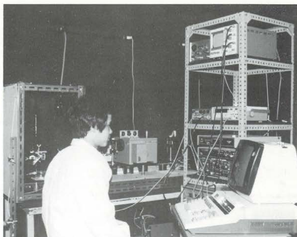
高速型酸素電極装置による光合成反応の測定
