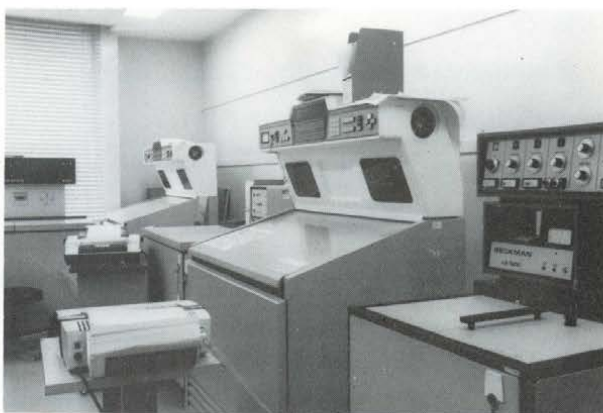
アイソトープを用いた研究及び放射線の安全管理のための各種放射線測定機器（写真：液体シンチレーションカウンタ）をはじめ最新の機器を設備している。
