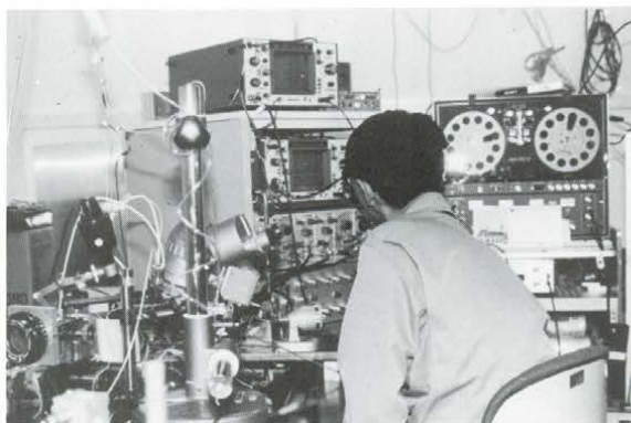
細胞内に白色雑音電流を流入して網膜内信号伝達機構を解析する実験
