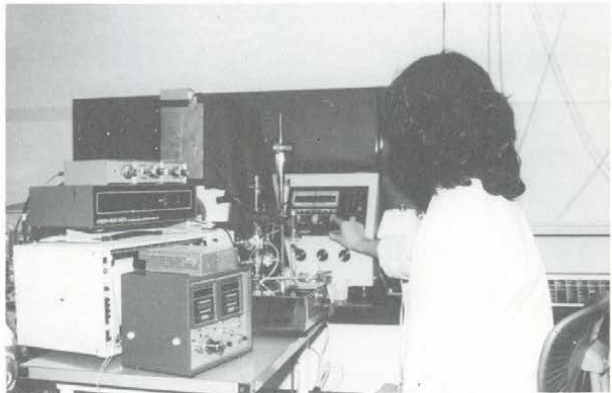
フィトクロムの水素イオン吸収及び放出と吸収スペクトル変化の同時測定装置
