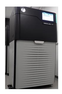
Sequelと比較し、ZMWの数が100万から800万と8倍になっています。またadaptive loadingという技術により、従来手法ではライブラリー濃度を調整して、個々のZMWに1分子のpolymeraseのみが入ったP1率と呼ばれる指標を最適化する試行錯誤が必要だったのですが、これが自動でできる状況になりました。
