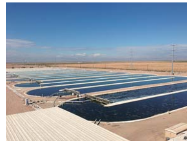
図3. レースウェイ・ボンド 澄んだ青空の強い陽射しの下、いかにすれば光合成を効率よく行い生産性を上げることができるのか、藻類培養企業等と協力し、研究を行っている。
