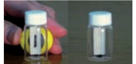
▲図2: ガラス容器内のコバルト・炭化水素分子磁石粉末。マグネットにガラス越しにもくっつく(上)、離すと落ちる(下)。
