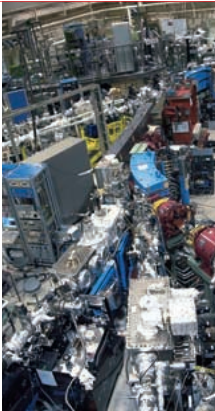
◀蓄積リング自由電子レーザー 分子科学研究所・極端紫外光実験施設に設置されている電子蓄積リング（周長50m）の一部を利用して自由電子レーザー研究を行っています。
