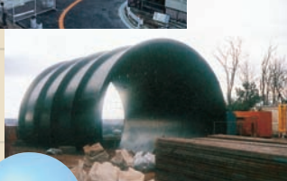
磁気共鳴装置 (MRI) 用に作られた直系7mの鋼管の磁気シールド
