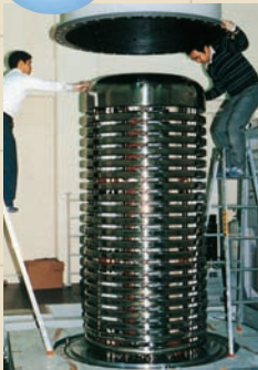
医学生物学専用の超高压電子顕微鏡(1,200kV)が搬入され、組み立てが始まる
