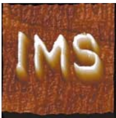
シリコン表面を酸化して、1.7ミクロン角の範囲に書かれた文字(1章)
