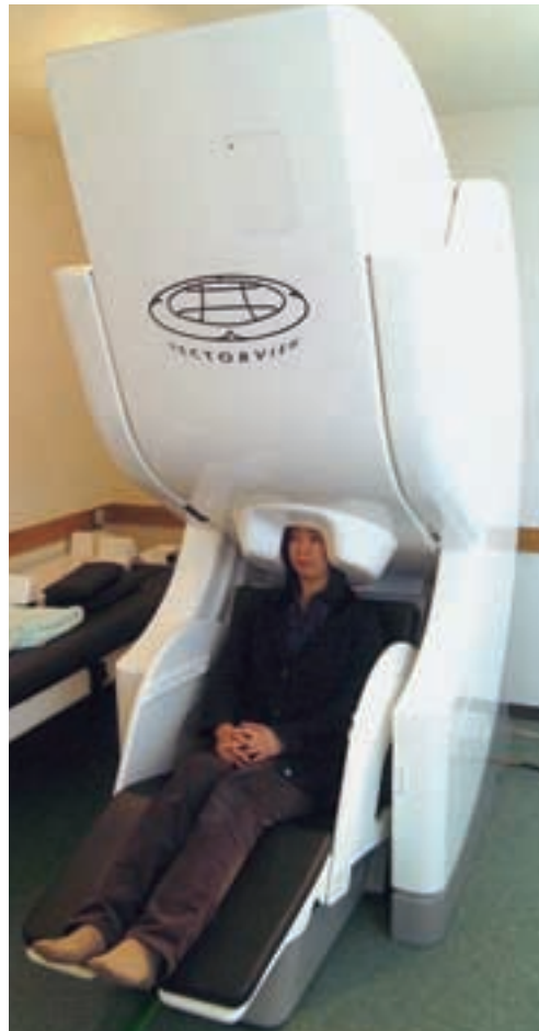
▼図1B:Neuromag社製306チャンネル脳磁場計測装置。
